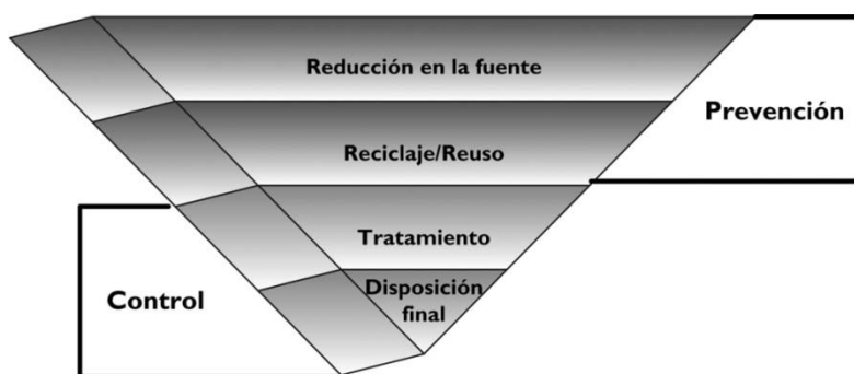
Figura 1. Esquema de los niveles de reducción de contaminación (ONUDI, 1999)
